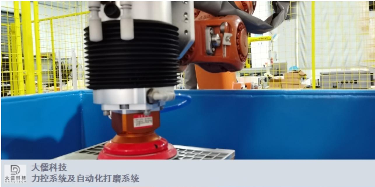
金属铸造成型后，有些需要打磨去除合模线，有些需要整体打磨掉表面瑕疵；金属铸件产品通常尺寸公差比较大，其中模具打磨抛光工艺非常复杂，精度要求高，且表面不规则；目前多数还只能依靠人工打磨；人工打磨的弊端很明显，劳动强度大，效率低；粉尘和噪音等对人体损伤很严重，对环境也造成极大的污染，实现自动化柔性打磨是迫切的需求，是必然的趋势。DFC力控系统的柔性力控制功能，可以解决这些问题，帮助企业实现自动化柔性打磨；而且打磨后的均匀性和一致性效果比人工打磨更好；
